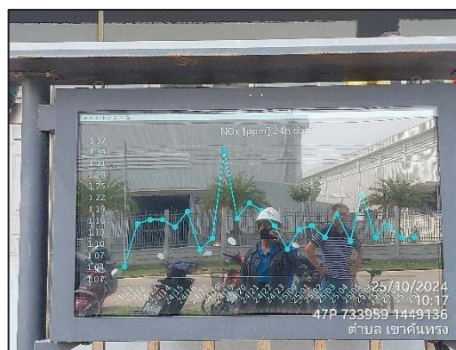
ภาพที่ 44 ติดตั้งเครื่องแสดงผลคุณภาพอากาศแบบ Real-time
