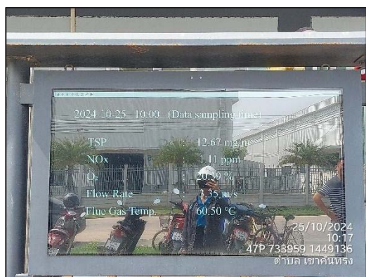
ภาพที่ 44 ติดตั้งเครื่องแสดงผลคุณภาพอากาศแบบ Real-time
